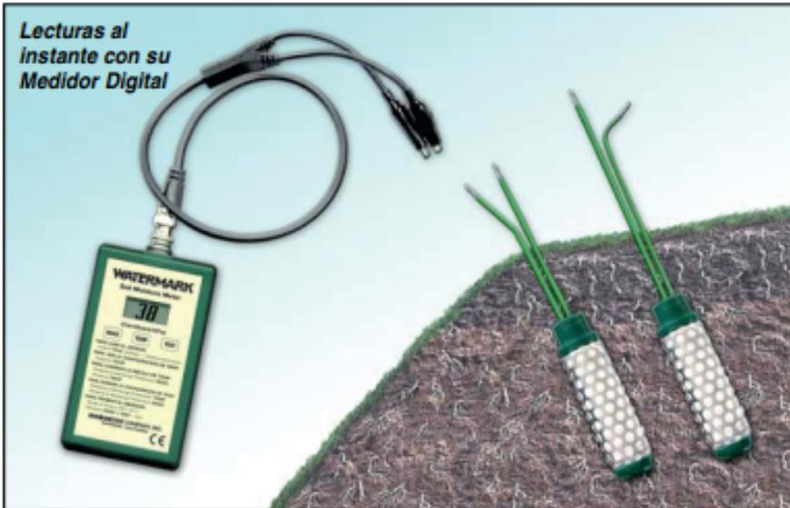
PRINCIPIO DE FUNCIONAMIENTO: El medidor WATERMARK® se ha diseñado para leer exclusivamente todos los sensores de humedad del suelo WATERMARK®. Estos sensores tienen una salida de 500 a 30,000 ohms de resistencia eléctrica que no es lineal. El medidor utiliza un medidor puente de resistencia de corriente alterna en estado sólido para la lectura de los sensores y convierte el valor de la resistencia en centibares (cb) o kilopascales (kPa) de tensión de agua del suelo.
